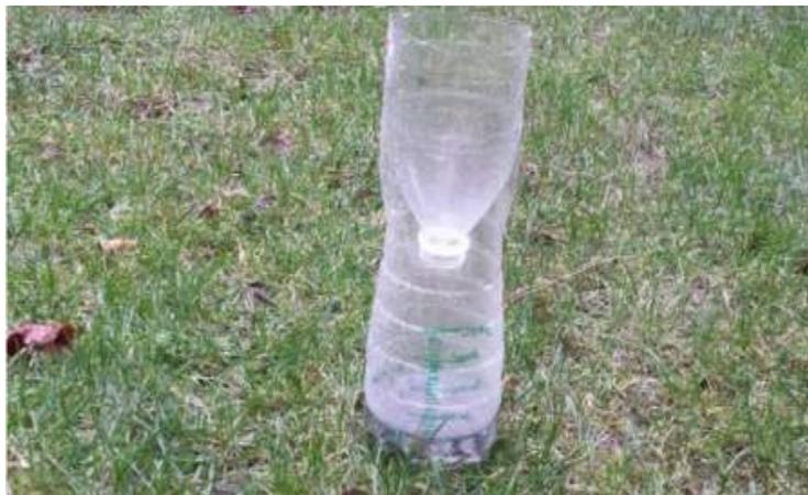
Tomar en cuenta que 20 ml en el depósito del pluviómetro, equivalen a una precipitación de 3,5 l/m<sup>2</sup> o 3,5 mm. Si se recogen 40ml, la precipitación será el doble. Si se acumulan 60ml, la precipitación será el triple, etc. Con estos datos lo más cómodo es elaborar una tabla que relacione la lectura del pluviómetro con la cantidad de precipitación:
