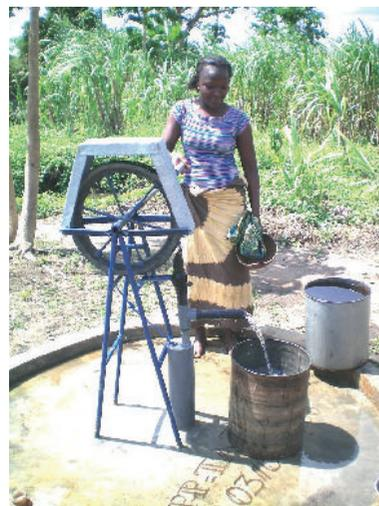
*Extracción de agua con bomba de mecate*
