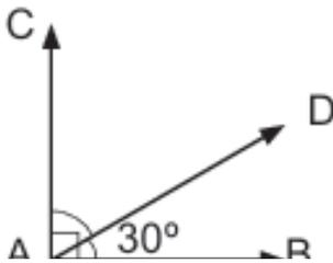
Se observa en la figura que los ángulos  $\angle BAD$  y  $\angle DAC$  son complementarios, por lo que  $\angle BAC = 90^\circ$ , entonces  $\angle BAD + \angle DAC = 90^\circ$ .
