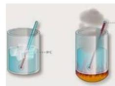
**Fundamento teórico:** El calor latente de fusión es la cantidad de energía que una sustancia necesita para cambiar del estado sólido al líquido sin que se modifique su temperatura. En el caso del hielo, este proceso ocurre a  $0^{\circ}\text{C}$ . Durante la fusión, el calor absorbido por el hielo se utiliza para romper las fuerzas de cohesión entre las moléculas, no para elevar la temperatura, por lo que esta se mantiene constante hasta que todo el hielo se derrite.
