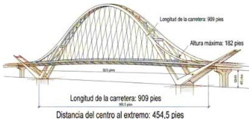
b) Considere que el punto más alto del puente está en el origen. Explique que representa "x" y "y" en la ecuación  $x^2 = 1135y$ . ¿Cómo se utiliza esta ecuación en el diseño y construcción de puentes?
