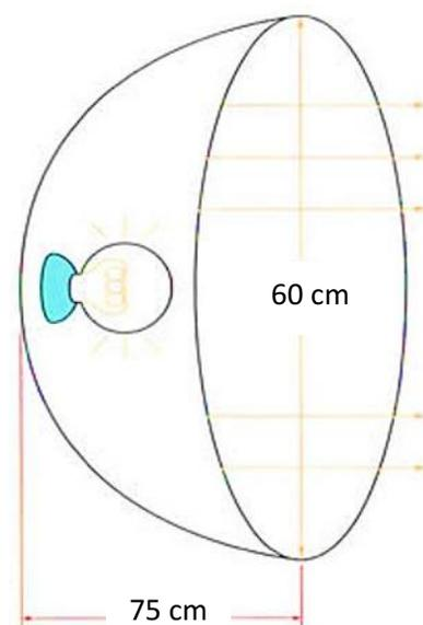
Luego usando la **Nota informativa**  $y^2 = 4px$ , y del siguiente grafico se puede apreciar que del punto  $P(30,75)$ ,  $x = 75 \wedge y = 30$
